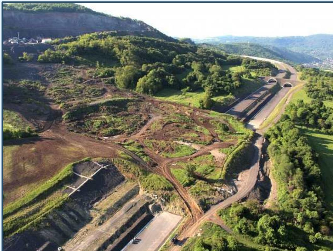
Silničáři od začátku září preventivně odvážejí desítky tun zeminy ze svahu u dálnice D8 nedaleko Prackovic nad Labem na Litoměřicku. Při extrémně silných deštích by se totiž mohla půda sesunout podobně jako před osmi lety, když se dálnice teprve stavěla.
